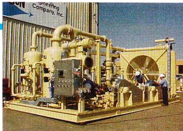
在小处理量上的应用,Hy-Bon库存有标准系列的机型,能降低成本并保证及时供货。我们拥有专利的蒸汽喷射系统结构简单、成本低,非常适合于油田开采设备中的储罐蒸汽回收。由于这套系统投资少运行费用低,即使在
