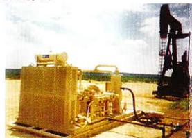
系统可以拖车牵引或者橇装形式交货。我们的设计更注重使用安全性及简便的操作维护,特配备了自动启停装置、易读表盘、指示灯、集成油路以及自动液体输送系统的分液罐。Hy-Bon提供马达驱动和引擎驱动两种形式,并根据客户的应用,提供各种选择配置。
